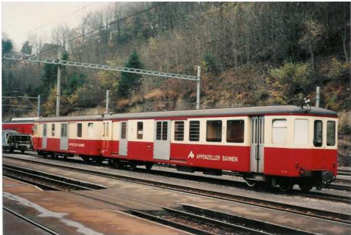
Gut sichtbar die unterschiedliche Bauart der beiden Steuerwagen, der eine mit 2. Kl.-Abteil, der andere ohne. Hier bereits in Herisau abgestellt für den Transport nach Spanien.
